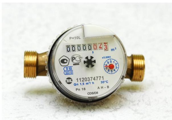
Счётчики холодной и горячей воды крыльчатые (одноструйные, сухоходные) CD SD 8 / CD SD PLUS предназначены для измерения объёма холодной и горячей воды по ГОСТ 2874, протекающей по трубопроводам в системах водопотребления при температуре от 5 0С до 90 0С и рабочем давлении в водопроводной сети не более 1,6 МПа (16 атм.).
